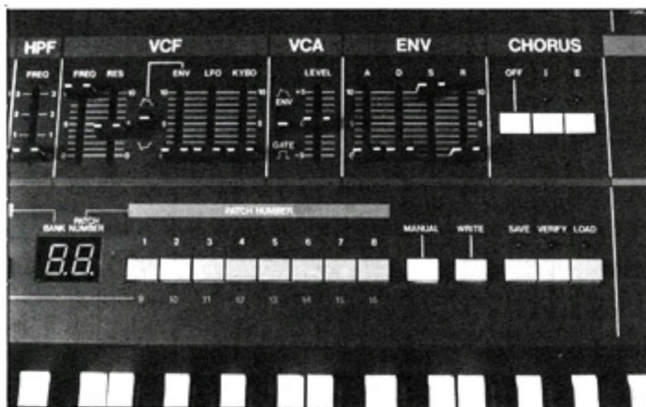
trôler les réglages de deux Juno-106 par le panneau d'un seul. La moindre modification apportée à la position d'un potentiomètre ou d'un sélecteur est immédiatement transmise au Juno-106 qui est esclave. Lorsque celui-ci reçoit les informations, il fait apparaître deux points sur son affichage, témoignant ainsi de la réception. Dans ce mode, on ne peut pas faire passer les changements de mémoires. Ici, on fait de la recherche.
